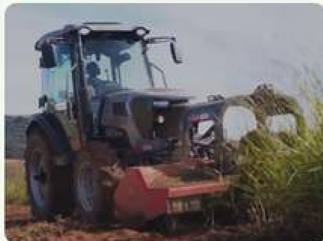
Roçada com trincha
